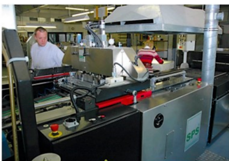
Abb. 1: Zum Teil selbstentwickelte Sicherheitseinrichtungen und Absaugeanlagen an allen Maschinen, Riebl-Siebdruck GmbH
